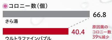
【出典】リンナイ 【実験方法】大腸菌液3mlを樹脂板に塗布し、8L/分、1分の条件で試験水を流水。その後、菌を採取し、37°C、24時間培養後のコロニー数を確認。
