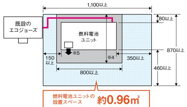
■ ベタ基礎    ■ 施工・メンテナンススペース    ← 排気の向き    — 給湯器行き配管(配管長は8m以内とする)
