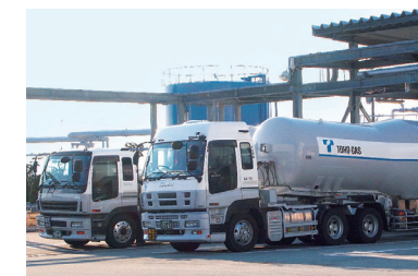
▲LNGを出荷するローリー車
