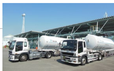
LNGローリー車
