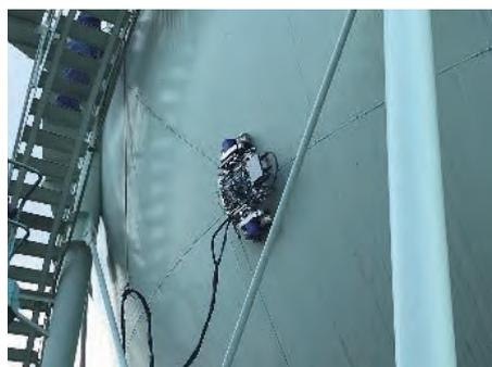
TOFDロボットによるホルダー検査
