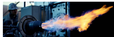
水素バーナ燃焼試験
