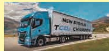
400馬力でLNG燃料により1,500km走行する大型天然ガストラック
