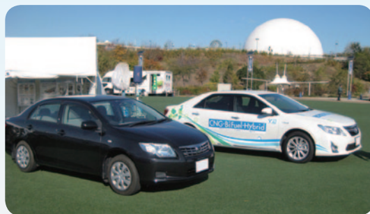
天然ガス乗用車(バイフュエル仕様)カムリハイブリッド(右)とカローラクシオ(左)
