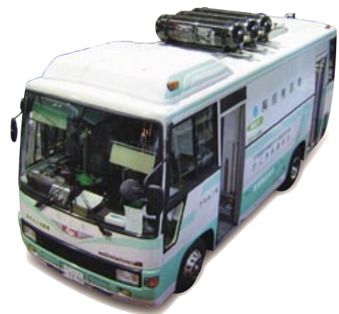
天然ガス自動車に改造中のレントゲン車
