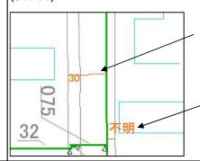
オレンジ色の線が引込管の埋設位置となります。 オレンジ色の数字が引込管のサイズとなります。
