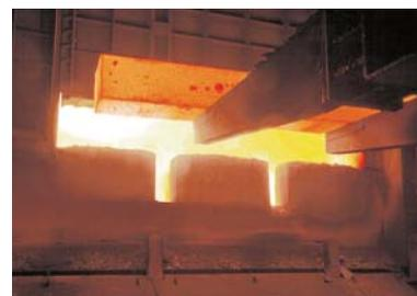
▲排熱回収により省エネ性を高めた金属加熱炉
