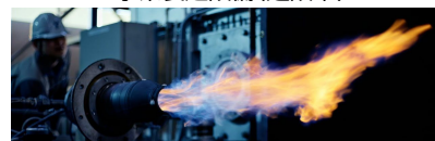
水素バーナ燃焼試験
