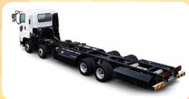
CNG ボンベを車軸間とリアオーバーハング(両側)に搭載 約180m 3 のCNGを充てん可能
